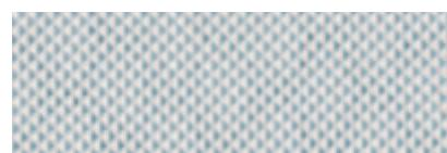
Sika introduce o tehnologie specială de lăcuire pentru membranele PVC, ce etanșează suprafața membranelor pentru a o proteja de influențele externe. Lăcuirea previne migrarea plastifiantului și extinde durata de exploatare a acoperișului.
