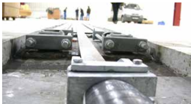
Canal de bază cu plăci CFRP post-tensionate
