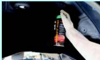
**SikaGard®-6055** este un insonorizant pe baza de bitum (nesupravopsibil) conceput sa se usuce repede si sa ramana texturat, prin simpla apasare a unui buton.
