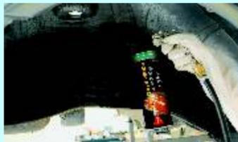
**SikaGard®-6050** este un insonorizant pe baza de bitum (nesupravopsibil) cu proprietati excelente de protectie impotriva coroziunii si de insonorizare.
