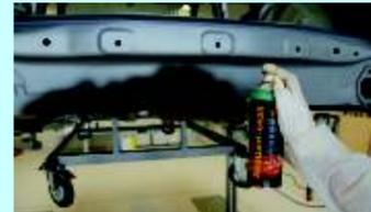
**SikaGard®-6455** este un insonorizant supravopsibil, pe baza de cauciuc care ofera o excelenta protectie impotriva coroziunii si sablarii, prin simpla apasare a unui buton. Destinat reparatiilor rapide pe zone mici.
