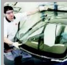
Asezati noul geam in pozitia corecta, reglati-l, fixati distantierele si marcati cu banda adeziva pozitia corecta. Aceasta operatiune se va efectua inainte de tratarea cu Sika® Activator PRO
