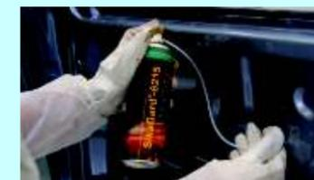
**SikaGard®-6215** ofera protectie la capilaritati prin simpla apasare a unui buton. A fost special formulata pentru a fi folosita din spray.
