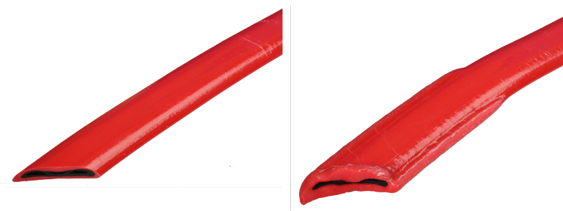
Profil înainte de expunere la apă (stânga) și după umflare (dreapta)
