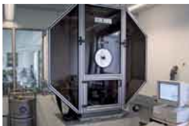
Echipament de testare a impactului cu pendul (ISO 11343) pentru viteze între 1.1 m/s – 5,24 m/s la temperaturi între – 50 °C și 80 °C. Intrucat sticla se deformeaza cu o viteza de maxim 4 m/s, aceste conditii sunt proprii simulării unei explozii provocata de bombe.
